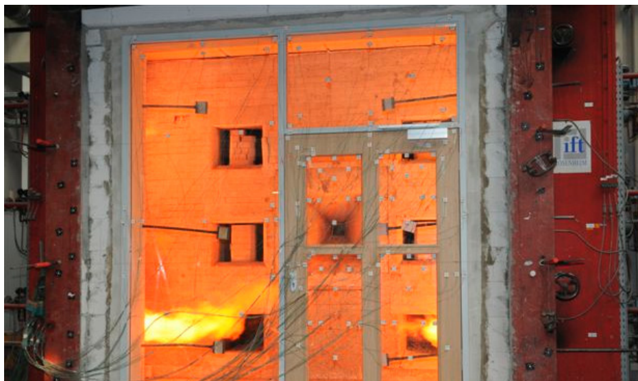
Abb. 1: Start einer Brandschutzprüfung im ift Rosenheim
