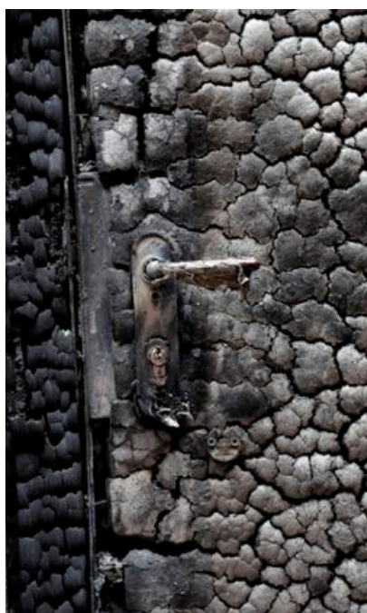
Abb. 3 KfV-Hauptschloss mit FS-Falle nach der Brandprüfung
